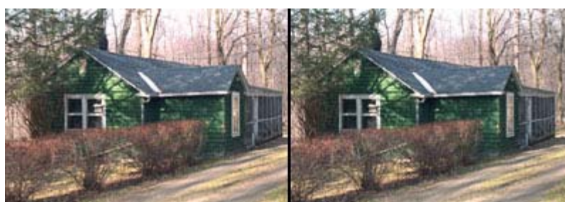
Figura 02: Imagens com pequenas variações de ângulo tais como são vistas normalmente pelos olhos. Essas imagens observadas por um estereoscópio unem-se no cérebro, nos dando a sensação de tridimensionalidade. Porém, olhar com os olhos cruzados é possível observar esta imagem em três dimensões sem auxílio de nenhum instrumento. Note-se a transparência e luminosidade superior que se ganha na imagem tridimensional assim formada.
